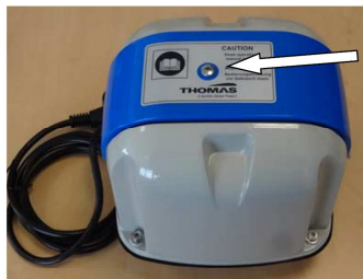
Photo 1 : Dévisser la vis sur le couvercle du filtre.
